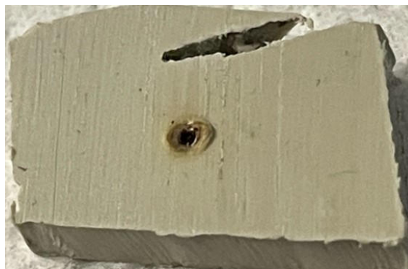
図5. 1064nmシステムではサンプルが焦げ、MIRA XTR DSではポリフェニレンエーテル (PPE) として識別された例
