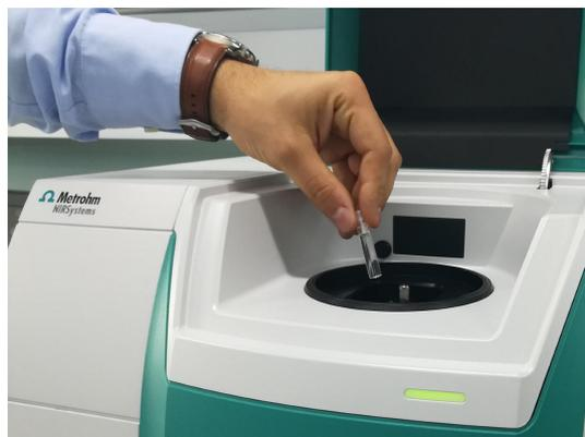
**Figure 1.** DS2500 Liquid Analyzer e un campione riempito in una fiala monouso.
