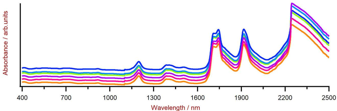
**Figura 2.** Selezione degli spettri di isocianato Vis-NIR ottenuti utilizzando un analizzatore XDS RapidLiquid e fiale monouso da 8 mm. Per motivi di visualizzazione è stato applicato un offset dello spettro.
