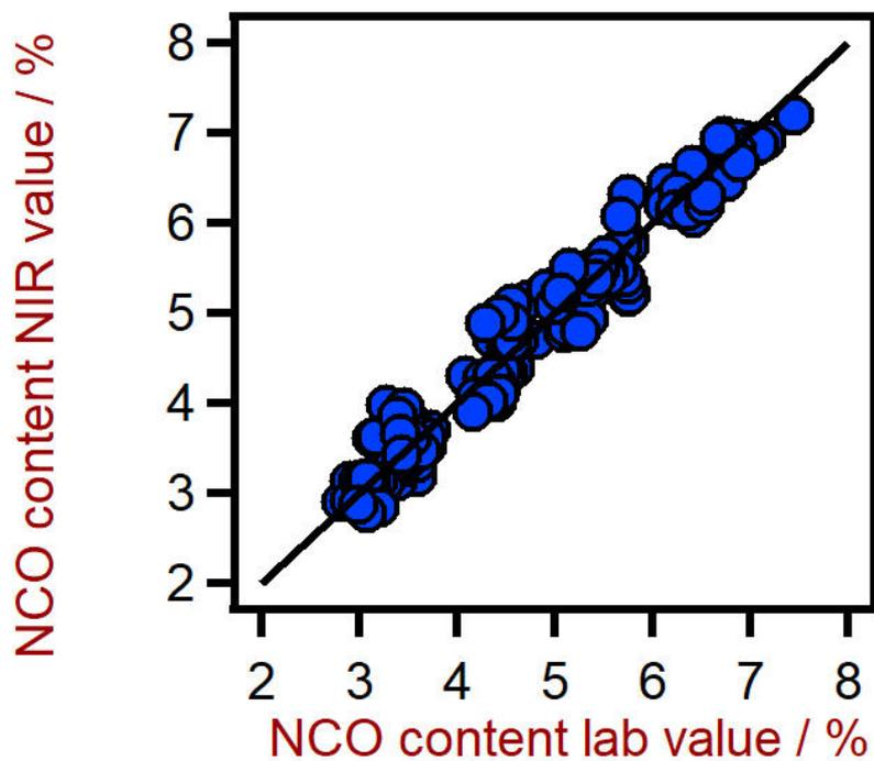
**Figura 3.** Diagramma di correlazione per la previsione del contenuto di isocianato (NCO) utilizzando un XDS RapidLiquid Analyzer. Il valore di laboratorio del contenuto di isocianato è stato valutato mediante titolazione.
