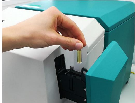
**Figura 1.** XDS RapidLiquid Analyzer e un campione di isocianato presente nella fiala monouso da 8 mm.
