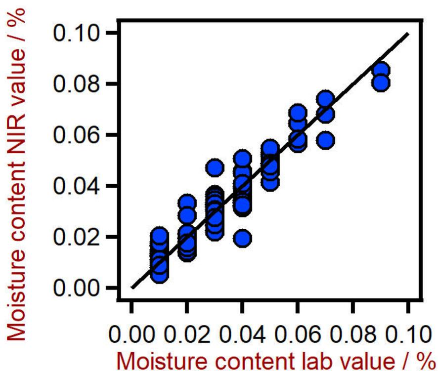
**Figure 5.** Diagramma di correlazione per la previsione del contenuto di umidità nei lubrificanti utilizzando un XDS RapidLiquid Analyzer. Il valore di laboratorio del contenuto di umidità è stato valutato utilizzando la titolazione Karl Fischer (KF).
