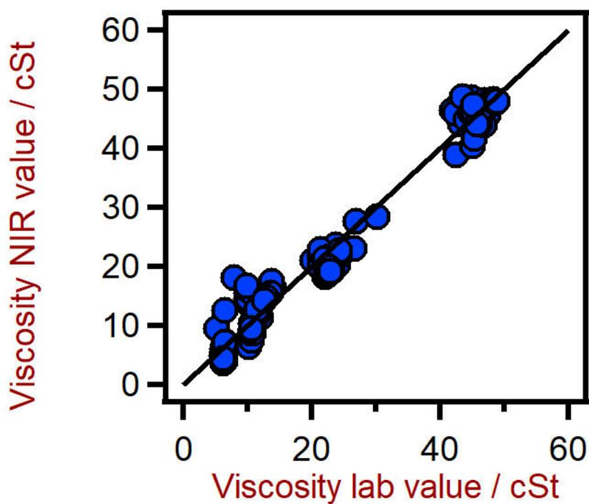
**Figure 4.** Diagramma di correlazione per la previsione della viscosità dei lubrificanti utilizzando un XDS RapidLiquid Analyzer. Il valore di laboratorio della viscosità è stato valutato utilizzando la viscosimetria.
