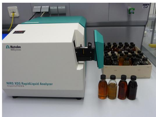
**Figure 1.** Analizzatore XDS RapidLiquid e campioni di lubrificante.
