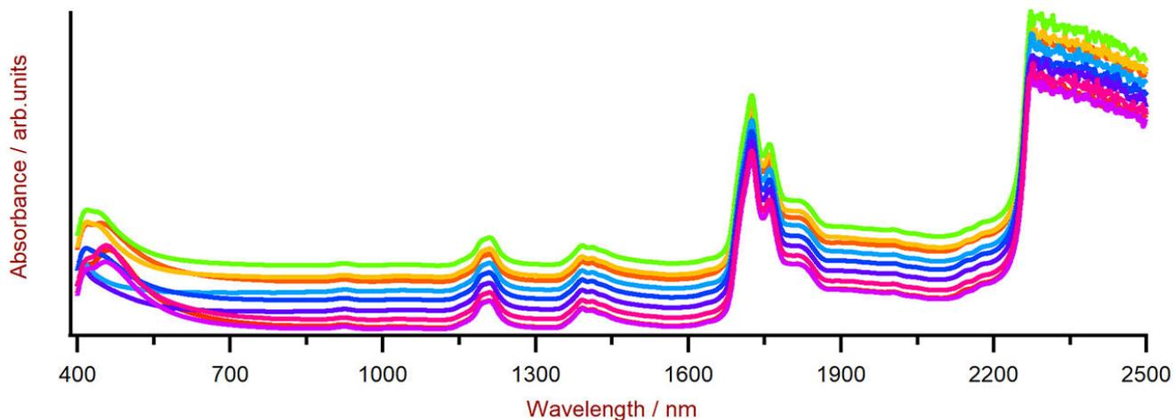
**Figure 2.** Selezione degli spettri Vis-NIR dell'olio lubrificante ottenuti utilizzando un XDS RapidLiquid Analyzer e fiale monouso da 8 mm. Per motivi di visualizzazione è stato applicato un offset dello spettro.
