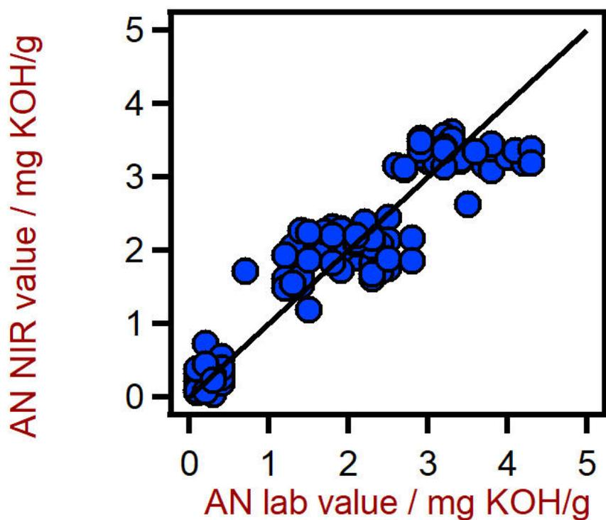
**Figure 3.** Diagramma di correlazione per la previsione del numero di acidità (AN) nei lubrificanti utilizzando un XDS RapidLiquid Analyzer. Il valore di laboratorio AN è stato valutato utilizzando la titolazione.
