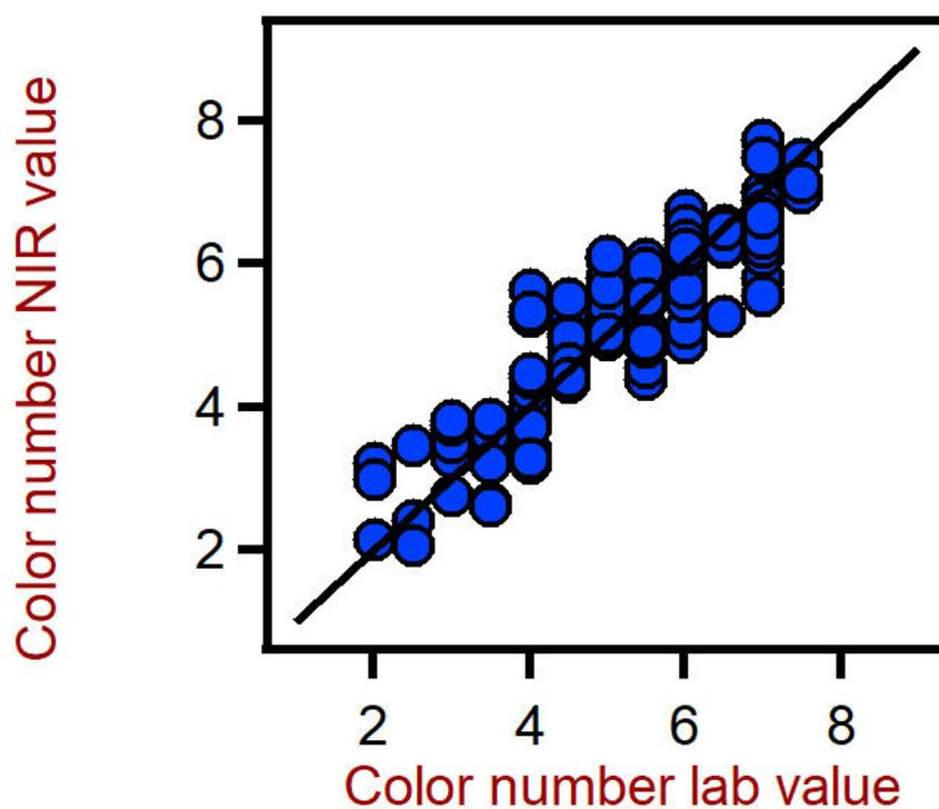
**Figure 6.** Diagramma di correlazione per la previsione del numero di colore nei lubrificanti utilizzando un XDS RapidLiquid Analyzer. Il valore di laboratorio del numero di ossidrilie è stato valutato utilizzando la fotometria.
