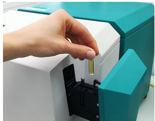
Figura 1. XDS RapidLiquid Analyzer e un campione di poliolo presente in una fiala monouso da 4 mm.
