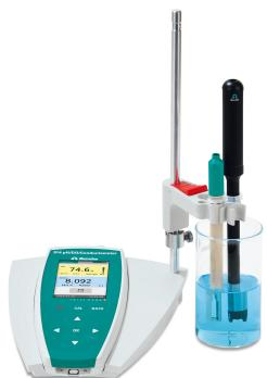
**914 pH/DO/Conductometer, modèle de laboratoire**
