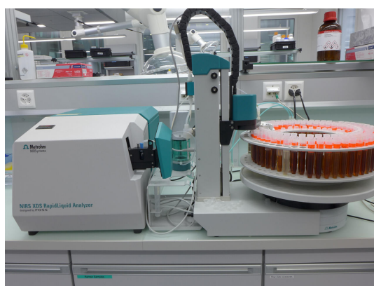
Figure 1. Analizador XDS RapidLiquid con celda de flujo de 5,0 mm y el procesador de muestras 815.
