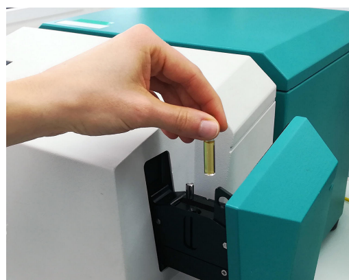
Figure 1. XDS RapidLiquid Analyzer y una muestra de poliol presente en un vial desechable de 4 mm.
