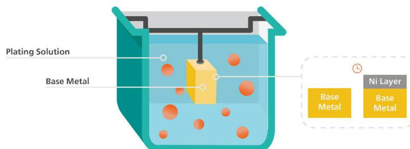
**Figure 1.** Diagrama esquemático del proceso de niquelado electrolítico.
