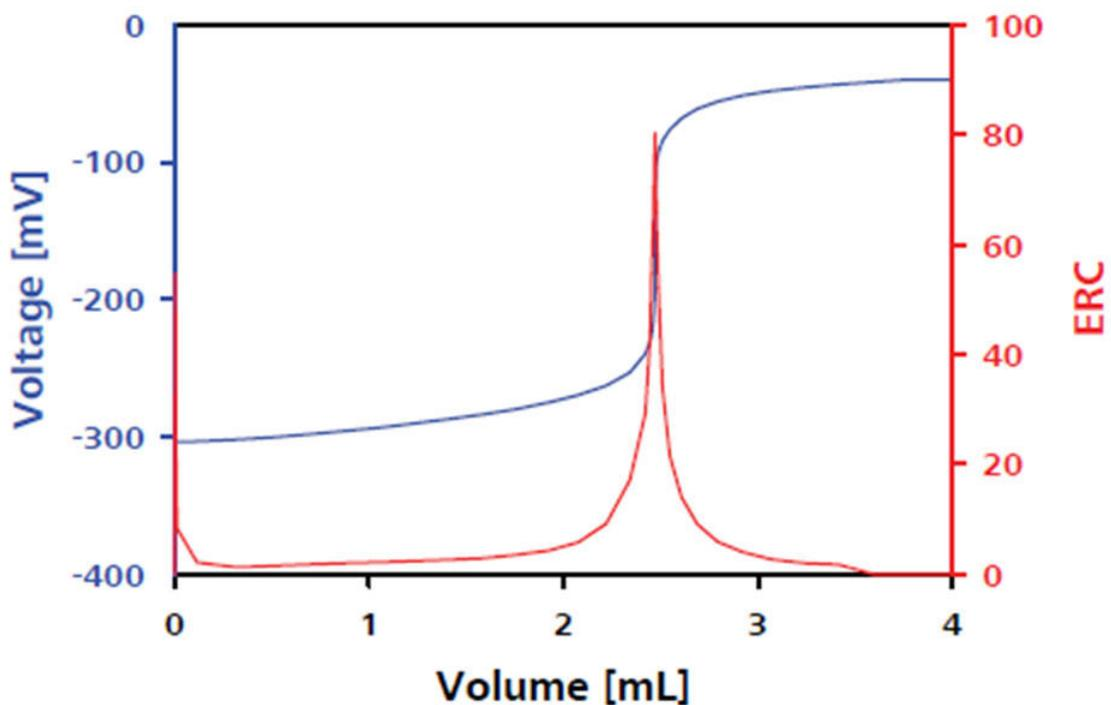
**Figure 3.** Curva de retitulación de yodo usando tiosulfato. ERC: Criterio de Reconocimiento de Puntos de Equivalencia.
