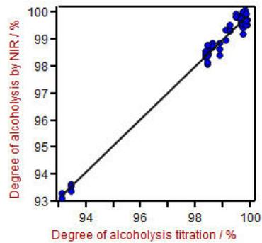
**Figure 3.** Gráfico de correlación para el grado de alcoholisis predicho por NIRS vs. método de laboratorio.
