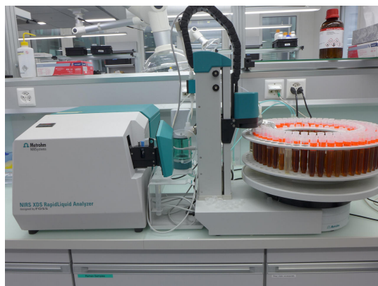
Figure 1. Analizador XDS RapidLiquid con celda de flujo de 5,0 mm y el procesador de muestras 815.
