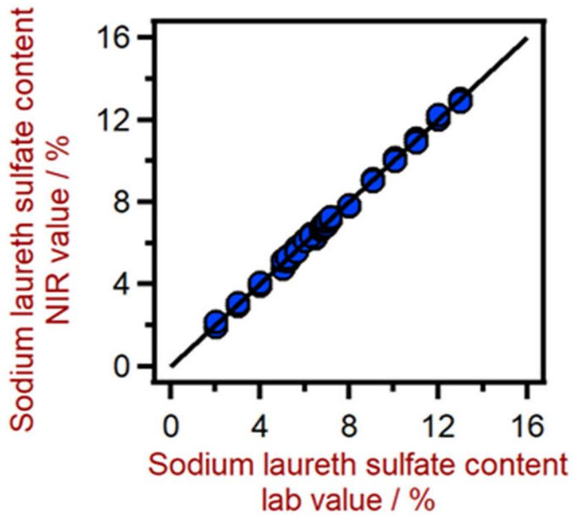
**Figure 3.** Diagrama de correlación para la predicción del contenido de laureth sulfato de sodio (SLS) utilizando un analizador de sólidos DS2500. El valor de laboratorio de SLS se evaluó mediante titulación.
