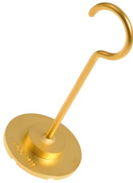
**Reflector de oro NIRS, 1 mm de espesor de capa total**
