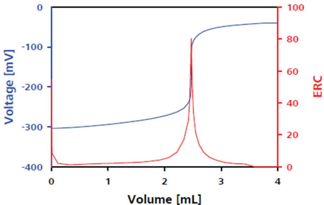
**Abbildung 3** Rücktitrationskurve von Jod mit Thiosulfat. ERC: Equivalence Point Recognition Criterion.
