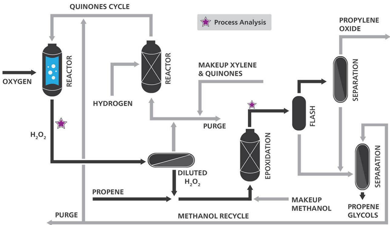
**Abbildung 1.** Schematisches Prozessdiagramm einer HPPO-Anlage für die nebenproduktfreie PO-Produktion. An den mit einem Stern gekennzeichneten Stellen kann eine Online Analytik für sicherere und effizientere Abläufe integriert werden.
