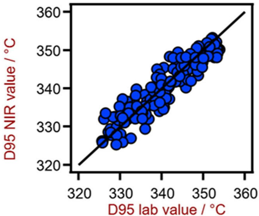
**Abbildung 6.** Korrelationsdiagramm für die Vorhersage des D95-Wertes mit einem XDS RapidLiquid Analyzer. Der D95-Laborwert wurde durch Destillation ermittelt.
