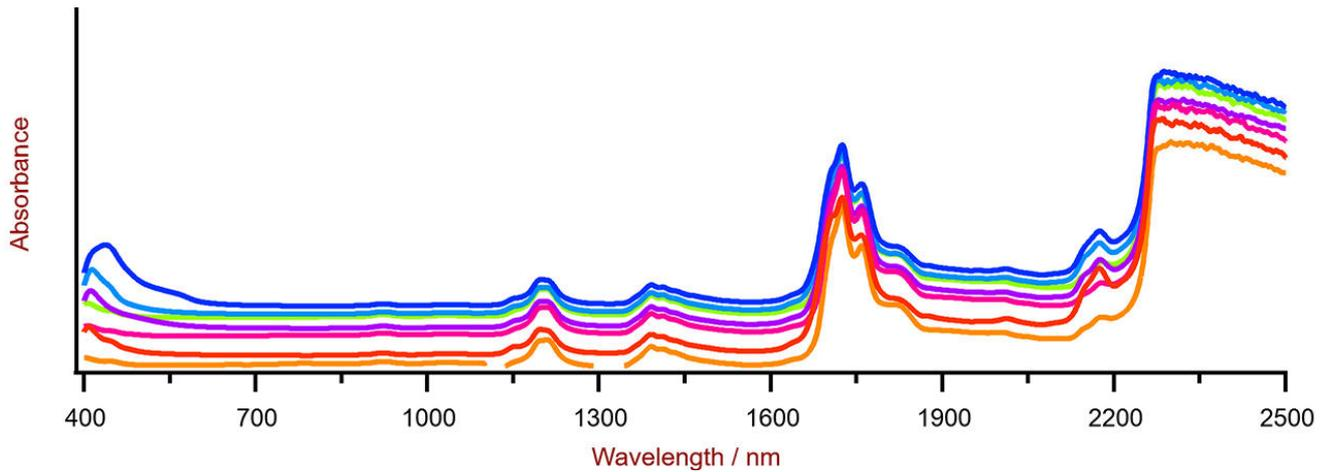
**Abbildung 2.** Auswahl von Diesel-Vis-NIR-Spektren, die mit einem XDS RapidLiquid Analyzer und 8-mm-Einwegfläschchen gewonnen wurden. Aus Darstellungsgründen wurde ein Spektren-Offset angewendet.
