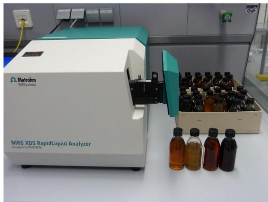
**Abbildung 1.** XDS RapidLiquid Analyzer und Schmierstoffproben.
