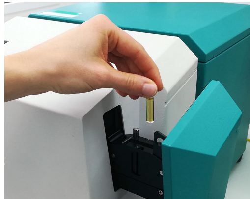
Abbildung 1 XDS RapidLiquid-Analyzer und 8-mm-Einwegfläschchen, gefüllt mit einer Benzinprobe.
