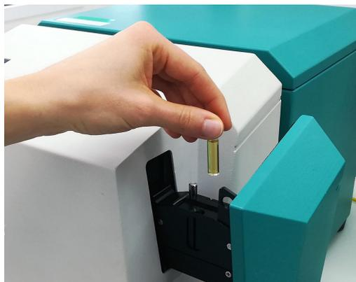
**Abbildung 1.** XDS RapidLiquid Analyzer und einer Isocyanatprobe, die sich in einem 8 mm Einwegfläschchen befindet.
