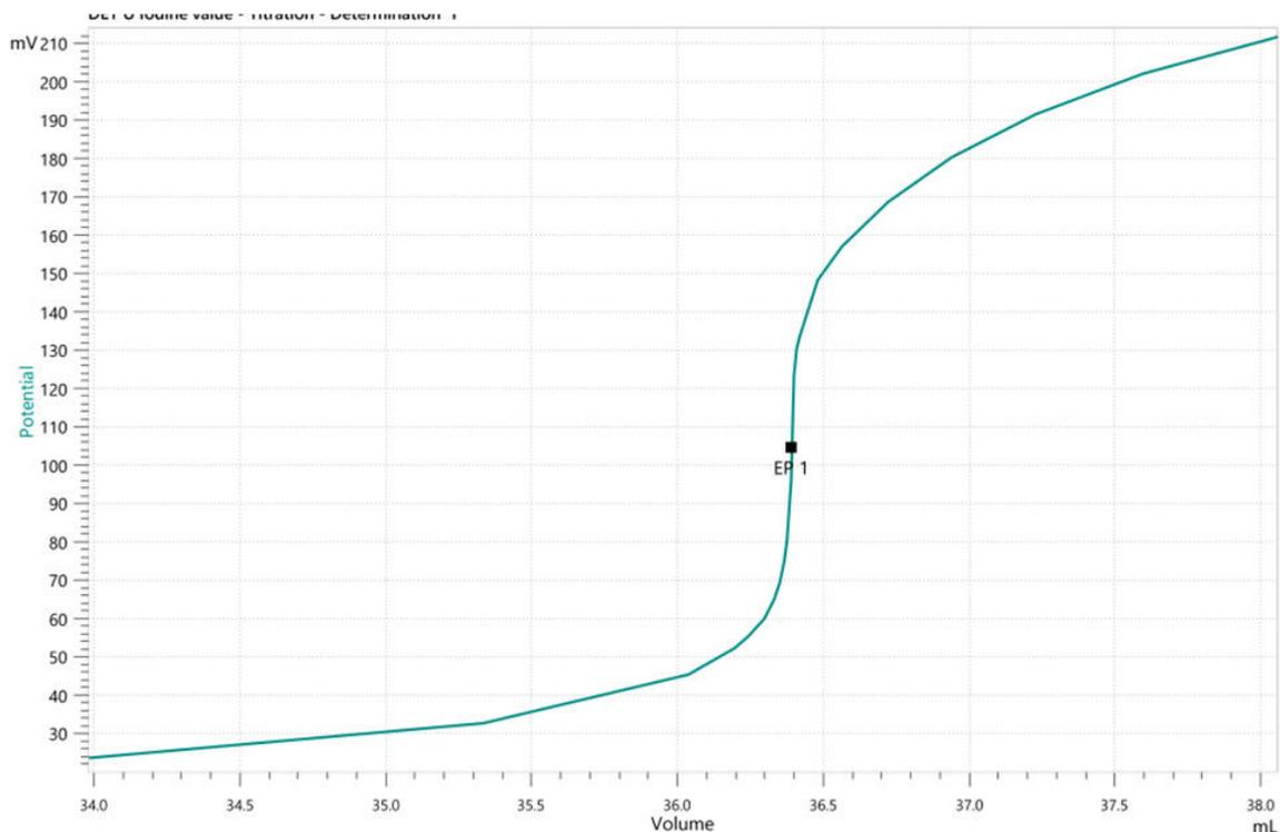
**Abbildung 2.** Titrationskurve der Bestimmung der Iodzahl in Olivenöl mit dem beschriebenen OMNIS-System.
