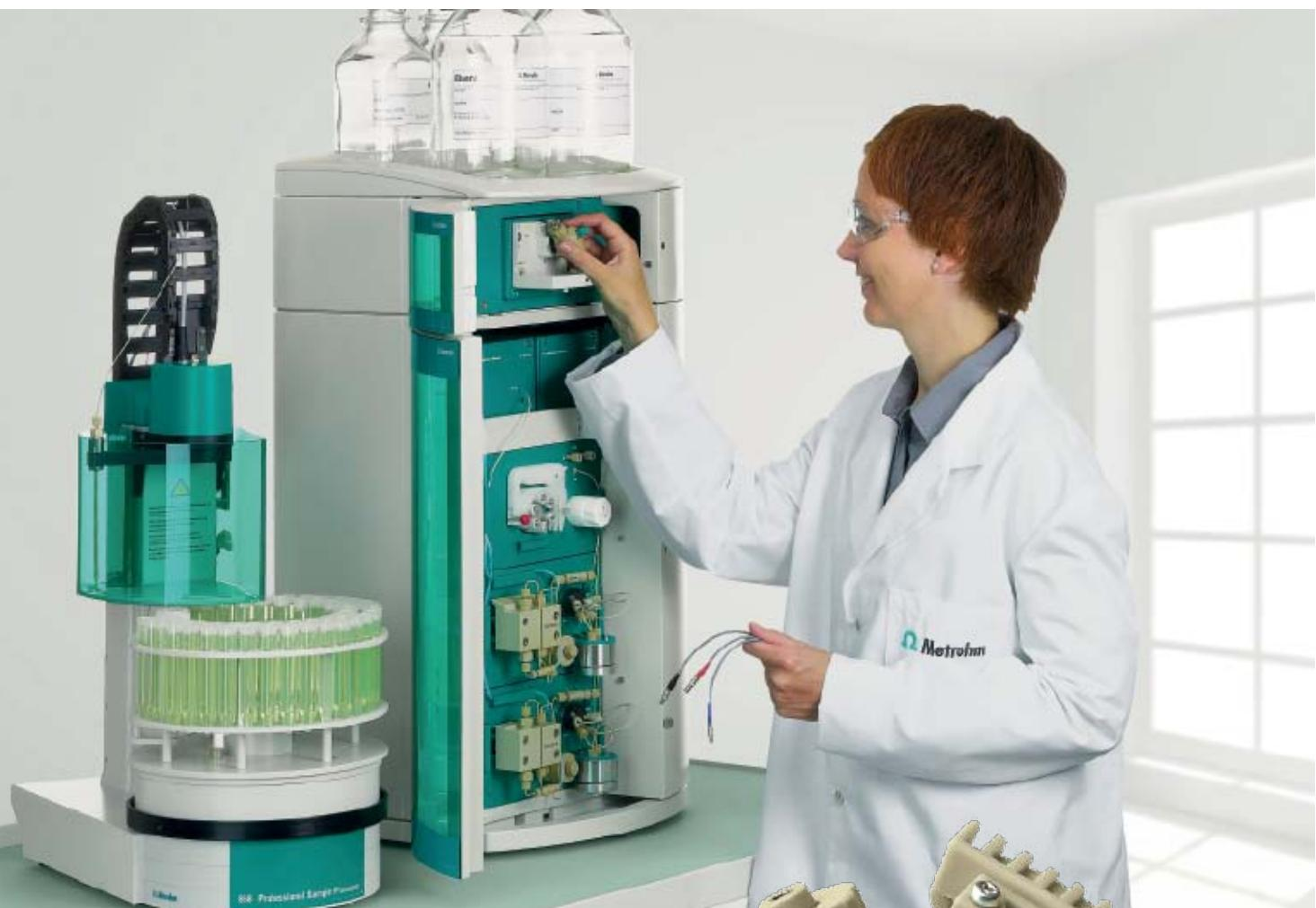
Die Ionenchromatographie wird als leistungsfähige Analysenmethode in sehr vielfältigen Applikationen eingesetzt. Für komplexe Analysenaufgaben werden neben dem Leitfähigkeitsdetektor oft auch alternative Detektoren wie der amperometrische Detektor oder der UV/VIS-Detektor benutzt.
