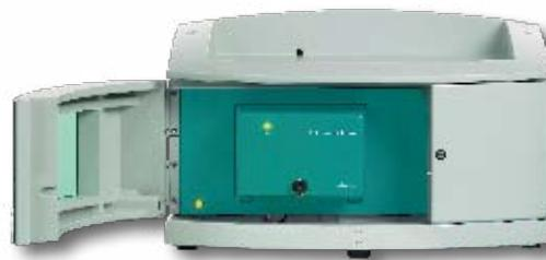
Auf der Analytica und Achema stellt Metrohm einen neuen amperometrischen Detektor vor, der das Portfolio der Ionenchromatographiegeräte abrundet. Sein Einsatz bietet sich immer dann an, wenn elektroaktive, also oxidierbare oder reduzierbare, Substanzen bestimmt werden. Durch die hohe Selektivität und Empfindlichkeit können Konzentrationen bis in den ng/l-Bereich genau analysiert werden.
