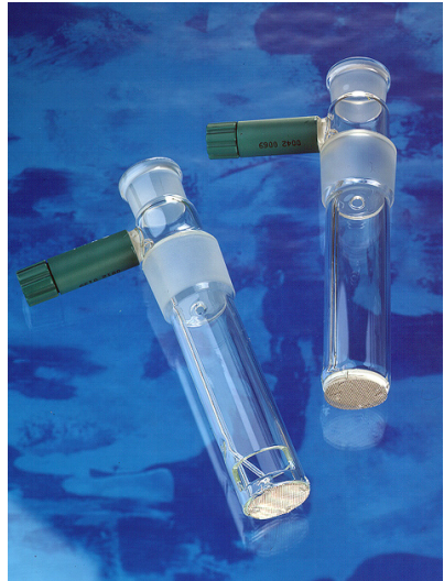
Generatorzellen für Metrohm-KF-Coulometer: links ohne, rechts mit Diaphragma
