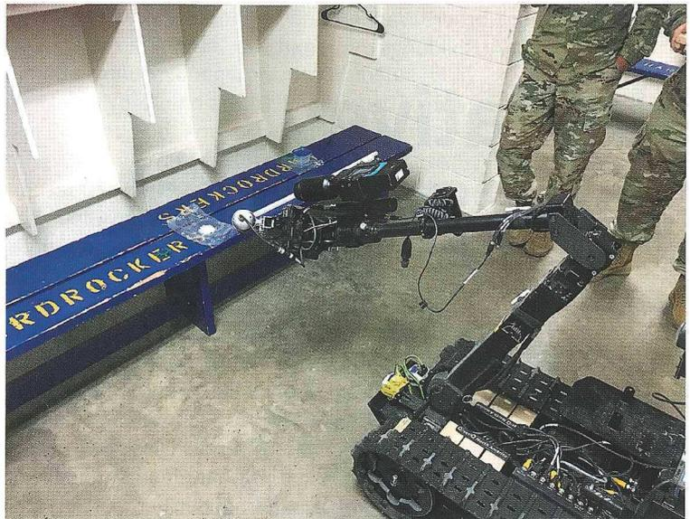
Mit dem Stand-Off-Attachment kann aus einer Entfernung bis zu 1,5 m gemessen werden. Roboter von GHOSTROBOTICS
