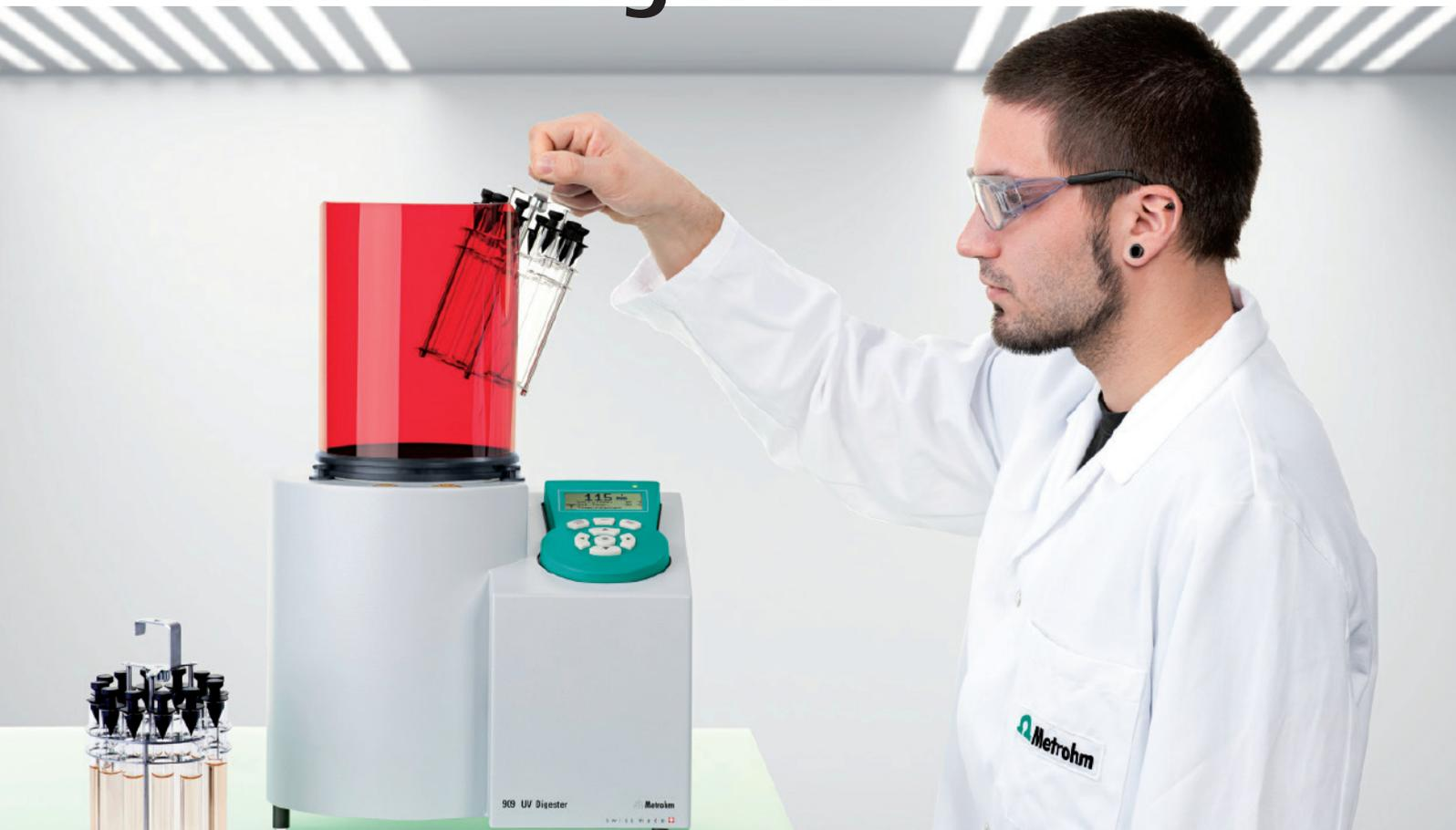
Probenvorbereitung für die Bestimmung von Schwermetallspuren
