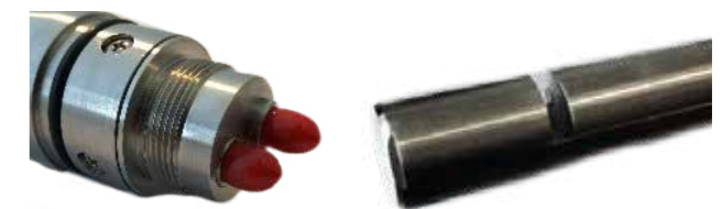
Transmissionssonde, links: Faseranschluss; rechts: Messspalt mit 2 mm OPL
