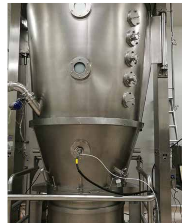
Implementierung einer Löffelsonde in einen Trockner
