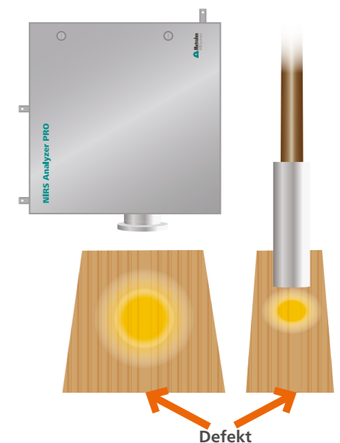
Veranschaulichung des Spotgrößenunterschieds zwischen einem NIRS Analyzer PRO und einer berührungslosen Sonde
