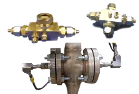
Oben links: Durchflusszelle für Transmissionssonden Oben rechts: Durchflusszelle für Transmissionssondenpaare. Unten: Beispiel für die Implementierung eines Transmissionssondenpaars direkt in eine Prozessrohrleitung
