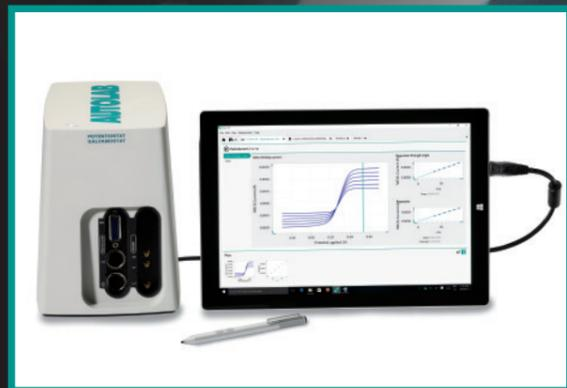
Ein elektrochemischer Messstand von Metrohm Autolab wie er in der Korrosionsforschung eingesetzt wird. Die Ergebnisermittlung und Auswertung erfolgt mittels spezieller Software am PC.
