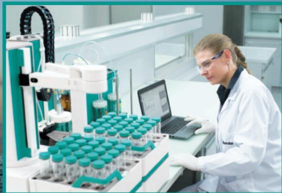
Unsere Automationslösungen ermöglichen einen hohen Probendurchsatz – beispielsweise bei der Bestimmung des Wassergehalts mittels Karl-Fischer-Titration in Treib- und Explosivstoffen.
