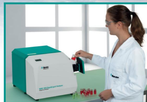
**Kerosin:** Mit unseren Geräten für Messungen mittels Nahinfrarotspektroskopie bestimmen Sie in Echtzeit mehrere Qualitätsparameter (z.B. Cetan-Index, Dichte, Aromaten u.a.m.) gleichzeitig – zerstörungsfrei und ganz ohne Lösungsmittel und Reagenzien.
