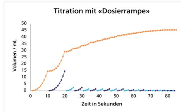
Titration mit der «Dosierrampe»: Durch längeres Drücken der Steuertaste wird die Dosierrate erhöht, kürzere Impulse führen zu einer schrittweisen Erhöhung im  $\mu\text{L}$ -Bereich.
