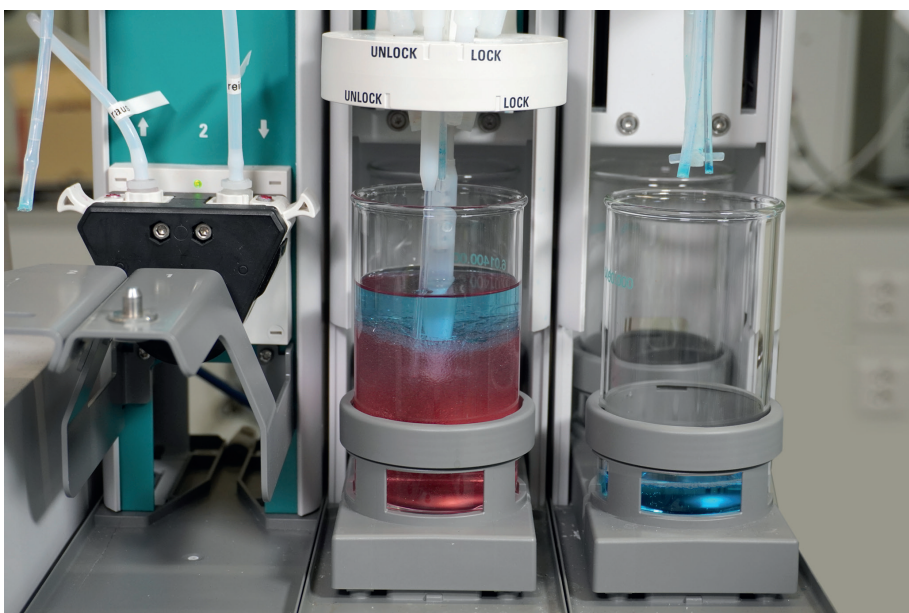
OMNIS erkennt die Phasengrenze äusserst präzise und trennt die organische von der wässrigen Phase.
