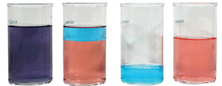
Extraktion schematisch dargestellt (v.l.n.r.): Gemisch, Gemisch nach Trennzeit, gesammelte organische Phase, restliche wässrige Phase.
