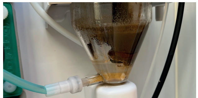
Abb. 4. Biologisches Wachstum stört die Messung nicht sonderlich (manuelle Reinigung alle 3 Monate)
